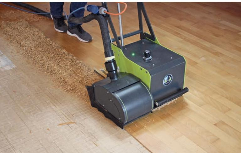
**Die Fräsmaschine Biber 200 von Wolff wurde speziell zum Entfernen von HDF- und MDF-Parkettflächen entwickelt.**
