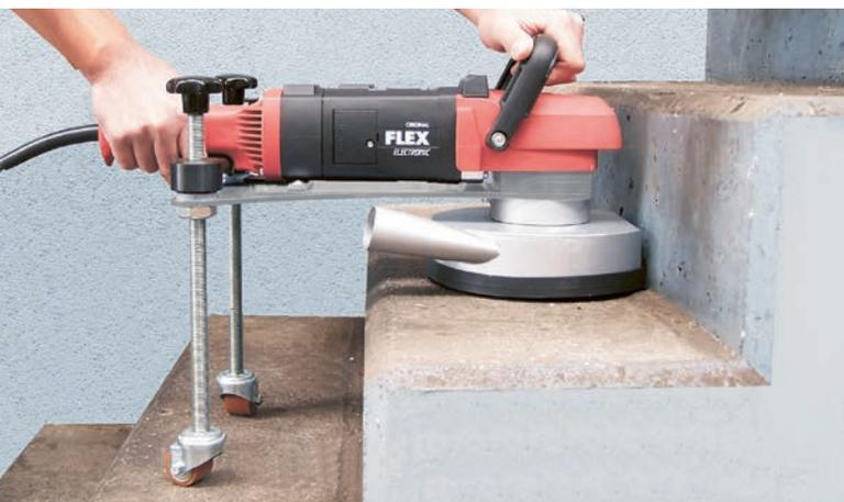
**Auch kleine Flächen lassen sich mit der Handfräse HF 180 Caddy mit ihrem nivellierbaren Fahrgestell absolut plan schleifen.**
