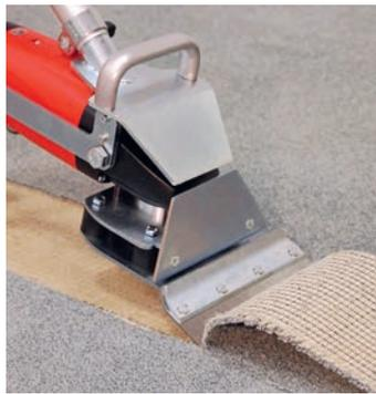
**Der Bullystripper von Rosset Technik ist ein oszillierendes Gerät, welches mit seiner Klinge Bodenbeläge ablöst.**
