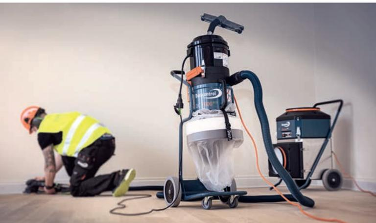
**Ein Staubsauger DC 2900 von Dustcontrol mit zweistufigem Filtersystem und der Luftreiniger DC Aircube 1200.**
