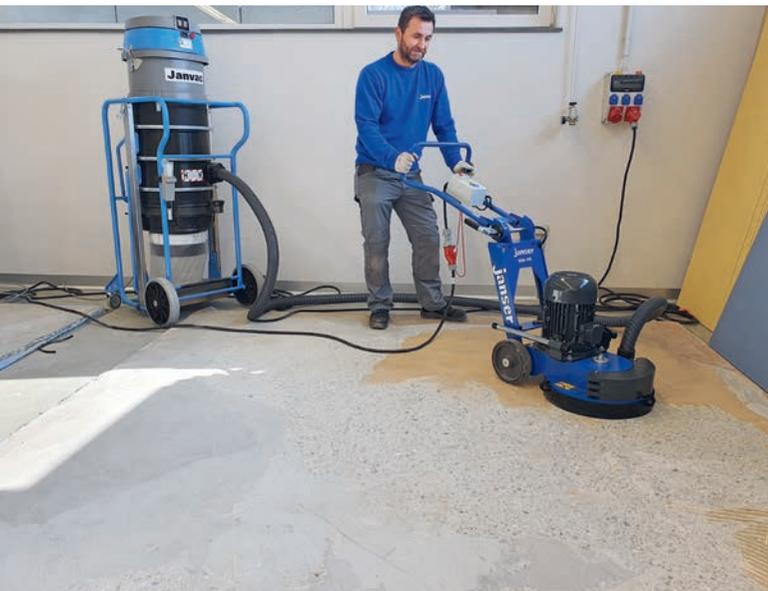
**Mit seinem schwenkbaren Schleifkopf kann die Bodenschleifmaschine BSM 400 von Janser bis zum Rand schleifen.**
